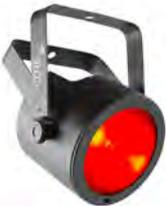
Proyector de leds COB RGB. 1 led de 80W (3 en 1). 2.143 lux a 2 m con lente de 25°, 405 lux a 2 m, (sin lente), 70°. Control DMX, Master/Slave, Wireless D-FI (opcional) y mediante infrarrojos, (IRC-6 opcional). Conectores: IEC IN/OUT, XLR IN/OUT de 3 polos. Control DMX: 3 ó 8 CH. Consumo: 72W. Alimentación: 100-240V AC, 50/60Hz. Dimensiones: 200x143x253mm. Peso: 2.0 Kg.
