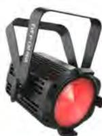
Proyector tipo Wash RGB de LEDs. 40 LEDs (13 rojos, 13 verdes, 14 azul) 130W en total. 2.190 lux a 2 m a 25 °; 1.100 lux a 2 m [sin objetivo instalado] a 35º; 727 lux a 2 m a 45º. . 3 ó 9 canales DMX. Frecuencia de estrobo: 0 to 34 Hz. Frecuencia PWM: 2 kHz. Lente de 25°, 35° y 45°. Control DMX ó Wireless D-FI (opcional). Conectores: PowerCon IN/OUT, XLR IN/OUT de 3 y 5 polos. Consumo: 111 W. Alimentación 100-240V; 50/60Hz. Dimensiones: 220x245x305mm. Peso 3,5 Kg.
