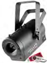
Proyector de gobos con led de 25W Blanco frio. Temperatura 6.500°K. 3.075 lux a 2 m con lente de 17°. 1.121 lux a 2 m con lente de 28°. Gobo de 25,74 mm exterior, 19,38 mm interior, 1 mm máximo de grosor. Zoom de 17° a 28°. Rotación de Gobo. Control DMX, Master/Slave, Wireless D-Fi (opcional) y mediante infrarrojos, (IRC-6 opcional). Conectores: IEC IN/OUT, XLR IN/OUT de 3 polos. Cuerpo de aluminio. Alimentación: 100-240V AC, 50/60Hz. Dimensiones: 238x124x244mm. Peso: 2.1 Kg.
