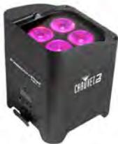
Proyector Led con batería y Wireless RGBAW-UV (6 en 1). 4 Led de 10W. 1.372 lux a 2 m. Lentes de 23º. Batería recargable. Múltiple tecnología inalámbrica: Wireless, infrarrojos, (IRC6 incluido). Control DMX 4, 6 ó 12 ch. Conectores: IEC IN/OUT, XLR IN/OUT de 3 polos. Consumo: 34W. Máximo tiempo de funcionamiento, (todo encendido 8 horas - 20 horas con un solo color). Alimentación 100-240V; 50/60 Hz. Dimensiones: 138x145x184mm. Peso 2.9 Kg.
