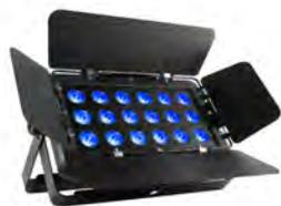
Proyector de leds RGB. 18 leds de 2.2W (3 en 1). 5.390 lux a 2 m con lente de 14º. Control DMX, Master/Slave, Wireless D-FI (opcional) y mediante infrarrojos, (IRC-6 opcional). Conectores: IEC IN/OUT, XLR IN/OUT de 3 polos. Control DMX: 3, 5, 9 ó 13 Ch. Consumo: 51W. Carcasa de aluminio. Alimentación: 100-240V AC, 50/60Hz. Dimensiones: 394x74x259mm. Peso: 3.6 Kg.
