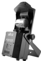
Scanner Barrel con led de 60W WHITE. 1.630 lux a 2 m con lente de 12º. Rueda de 8 colores + blanco. Rueda de gobos de 7 + blanco (5 de metal y 2 de cristal). Prisma de 3 caras. Dimmer, Strobe. Control DMX, automático, Master /Slave, al ritmo de la música ó infrarrojos (IRC6 opcional). 7 ó 11 Ch DMX. Tilt 90º. Conectores: IEC IN/OUT, XLR IN/OUT de 3 polos. Consumo: 102W. Alimentación 100-240V; 50/60 Hz. Dimensiones: 430x255x147mm. Peso 4,6 Kg.
