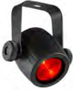
Proyector de leds PIN SPOT. 1 led Cool White de 5W. 3.558 lux a 2 m con lente de 8°. Incluye: 1 pack de 4 gelatinas de diferentes colores. Control mediante infrarrojos, (IRC-6 opcional). Consumo: 8W. Alimentación: 100-240V AC, 50/60Hz. Dimensiones: 117x104x68mm. Peso: 0.5 Kg.
