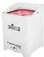
Proyector Led IP con batería y Wireless RGBA (4 en 1). 4 Led de 5 W. 2.300 lux a 2 m. Lentes de 15°. Batería recargable. Múltiple tecnología inalámbrica: Wireless, infrarrojos, (IRC6 incluido). IP-54. Control DMX 4, 6 ó 12 ch. Conectores: IEC IN. Consumo: 40W. Máximo tiempo de funcionamiento, (todo encendido 8 horas - 20 horas con un solo color). Alimentación 100-240V; 50/60 Hz. Dimensiones: 138x145x191mm. Peso 3.6 Kg. Acabado en color Blanco.
