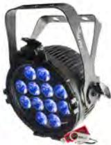
Proyector de leds RGBWA-UV. 12 leds de 10W (6 en 1). 3.218 lux a 2 m con lente de 24º. Control DMX, Master/Slave, Wireless D-FI (opcional) y mediante infrarrojos, (IRC-6 opcional). Conectores: IEC IN/OUT, XLR IN/OUT de 3 polos. Control DMX: 6, 7 ó 12 Ch. Consumo: 96W. Carcasa de aluminio. Alimentación: 100-240V AC, 50/60Hz. Dimensiones: 253x98x290mm. Peso: 3.3 Kg.
