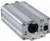
Convertidor que funciona con una interfaz Art-Net a DMX ó DMX a la interfaz Art-Net. Cuenta con un nodo Art-Net / SACN multiusuario que convierte un cable Ethernet con RJ45 ARTNET a 2 universos DMX, (1024 canales). DMX-AN admite alimentación a través de Ethernet (POE) ó una fuente de alimentación externa y ambas salidas pueden ajustarse a Art-Net o SACN. Conectores: 2 XLR de 3 polos. Alimentación: adaptador de 100-240V; 50/60 Hz a 9V DC 500mA. Dimensiones: 120x64x39mm. Peso 0,2 Kg.
