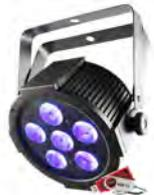
Proyector de leds RGBWA-UV. 6 leds de 10W (6 en 1). 747 lux a 2 m con lente de 23°. Control DMX, Master/Slave, Wireless D-FI (opcional) y mediante infrarrojos, (IRC-6 opcional). Conectores: IEC IN/OUT, XLR IN/OUT de 3 polos. Control DMX: 6, 8 ó 12 Ch. Consumo: 63W. Alimentación: 100-240V AC, 50/60Hz. Dimensiones: 211x92x244mm. Peso: 1.6 Kg.
