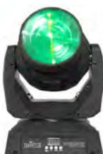
Cabeza móvil led Beam. 1 led de 75W, Blanco, 139.200 lux a 2 m. Lente de 4°. Rueda de colores 8 + blanco. Rueda de gobos de 5 gobos fijos + blanco. Strobe de 0-20 flashes por segundo. Display LCD. Control DMX, automático, Master/Slave ó al ritmo de la música. Control DMX 8 ó 14 canales. Pan: 540, Tilt: 270. Conectores: IEC IN/OUT, XLR IN/OUT de 3 polos. Consumo: 269W. Alimentación 100-240V; 50/60 Hz. Dimensiones: 470x340x287mm. Peso 9 Kg.
