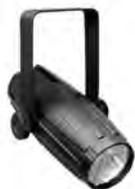
Proyector de led PIN SPOT. 1 led Cool White de 3W. 4.120 lux a 2 m con lente de 6°. 1.335 lux a 2 m con lente de 9°. Incluye lente de 6° y de 9° y 1 pack de 4 gelatinas de diferentes colores. Consumo: 4W. Alimentación: 100-240V AC, 50/60Hz. Dimensiones: 193x105x148mm. Peso: 0.4 Kg.
