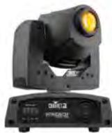
Cabeza móvil led SPOT. 1 led de 32W, Blanco. Lente de 17º, 4.860 lux a 2m. Rueda de colores 9 + blanco. Rueda de gobos fijos con 9 gobos + blanco. Dimmer de 0 a 100%. Strobo de 0-20 flashes por segundo. Display LCD. Control DMX, automático, Master/Slave ó al ritmo de la música. Control DMX 6 ó 11 canales. Pan: 540, Tilt: 270. Conectores: IEC IN/OUT, XLR IN/OUT de 3 polos. Consumo: 95W. Alimentación 100-240V; 50/60 Hz. Dimensiones: 291x211x205mm. Peso 4.4 Kg.
