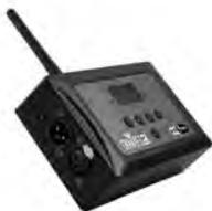
Transmisor-receptor inalámbrico de DMX. Trabaja con el protocolo D-Fi para enviar y recibir señales DMX de forma inalámbrica. Para una comunicación más estable entre múltiples unidades, opera en un rango de frecuencia de 2.4 GHz y tiene incorporada una función 'auto' que encuentra la mejor frecuencia disponible de manera automática, y ajusta las unidades de forma rápida y sencilla. Alimentación: adaptador de 100-240V; 50/60 Hz a 9V DC 500mA. Dimensiones: 102x82x41mm. Peso 0,6 Kg.
