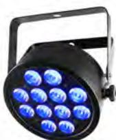
Proyector de leds RGB. 12 leds de 3W (3 en 1). 3.801 lux a 2 m con lente de 15°. Control DMX, Master/Slave, Wireless D-FI (opcional) y mediante infrarrojos, (IRC-6 opcional). Conectores: IEC IN/OUT, XLR IN/OUT de 3 polos. Control DMX: 3 ó 8 Ch. Consumo: 39W. Alimentación: 100-240V AC, 50/60Hz. Dimensiones: 227x84x252mm. Peso: 1.8 Kg.
