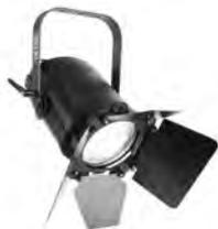
Proyector de teatro con LED de 50W Fresnel, (3.500°K). 4.780 lux a 2 m a 17°, 998 lux a 2 m a 50°. Zoom manual de 17° a 50°. Viseras de recorte (incluidas). Control DMX, manual con menú de control de Dimmer y Strobe ó Wireless D-FI (opcional). 1 ó 3 canales DMX. Conectores: PowerCon IN/OUT, XLR IN/OUT de 3 polos. Alimentación 100-240V; 50/60Hz. Dimensiones: 281x212x328mm. Peso 3,9 Kg.
