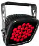
Proyector de leds IP RGB. 24 leds de 3W (3 en 1). 5.850 lux a 2 m. Lentes de 20°. IP-65. Control DMX, Master/Slave y Auto. Control DMX: 3, 5 ó 9 ch. Conectores: IP POWER y DMX IN/OUT. Consumo: 82W. Cuerpo de aluminio. Alimentación: 100-240V AC, 50/60Hz. Dimensiones: 301x134x268mm. Peso: 6.2 Kg.
