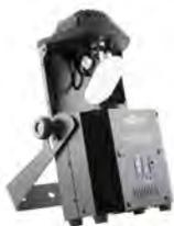
Scanner con led de 60W WHITE. 9.110 lux a 2 m con lente de 15º. Rueda de 8 colores + blanco. Rueda de gobos de 7 + blanco (5 de metal y 2 de cristal). Prisma de 3 caras. Dimmer, Strobe. Control DMX, automático, Master /Slave, al ritmo de la música ó infrarrojos (IRC6 opcional). 7 ó 11 Ch DMX. Tilt 90º. Conectores: IEC IN/OUT, XLR IN/OUT de 3 polos. Consumo: 102W. Alimentación 100-240V; 50/60 Hz. Dimensiones: 430x255x140mm. Peso 4,6 Kg.
