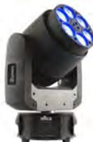
Cabeza móvil led RGBW Wash con zoom motorizado. 6 leds de 21W RGBW (4 en 1). Zoom ajustable de 7º a 53º. 16.000 lux a 2 m con 7º. 1.350 lux a 2 m con 53º. Dimmer de 0 a 100%. Strobo de 0-20 flashes por segundo. Display LCD. Control DMX, automático, Master/Slave ó al ritmo de la música. Control DMX 15 ó 30 canales. Pan: 540, Tilt: 270. Conectores: IEC IN/OUT, XLR IN/OUT de 3 polos. Consumo: 232W. Alimentación 100-240V; 50/60 Hz. Dimensiones: 386x278x278mm. Peso 9.2 Kg.
