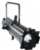
Proyector de recorte variable LED. 3.500°K. 15.100 lux a 2 m a 14°, 3.800 lux a 2 m a 30°. Led de 100W. Gobo de 66mm exterior, 48mm interior. Zoom manual de 14° a 30°. Cuchillas para recorte con giro suave y preciso. Porta filtro y Porta gobos (incluidos). Control DMX, Manual con menú de control de Dimmer y Strobe ó Wireless D-FI (opcional). 1 ó 3 canales DMX. Conectores: IEC IN/OUT, XLR IN/OUT de 3 polos. Alimentación 100-240V; 50/60Hz. Dimensiones: 611x183x430mm. Peso 5,7 Kg.
