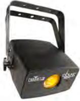
Proyector de efectos de agua multicolor con led. 1 led de 30W White. Lente de 59°. Rueda de colores de 5 + Blanco. 2 Ruedas de cristal texturizado con control independiente de efecto y color. Control DMX, Master/Slave, Wireless D-Fi (opcional) y mediante infrarrojos (IRC-6 opcional). Conectores: IEC IN/OUT, XLR IN/OUT de 3 polos. Control DMX: 3 Ch. Consumo: 37W. Carcasa metálica. Alimentación: 100-240V AC, 50/60Hz. Dimensiones: 195x228x246mm. Peso: 2.7 Kg.
