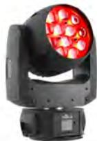
Cabeza móvil led RGBW Wash con zoom motorizado. 12 leds de 15W RGBW (4 en 1). Zoom ajustable de 14º a 58º. 25.610 lux a 2 m con 14º. 1.960 lux a 2 m con 58º. Dimmer de 0 a 100%. Strobo de 0-20 flashes por segundo. Display LCD. Control DMX, automático, Master/Slave ó al ritmo de la música. Control DMX 14 ó 29 canales. Pan: 540, Tilt: 270. Conectores: IEC IN/OUT, XLR IN/OUT de 3 polos. Consumo: 207W. Alimentación 100-240V; 50/60 Hz. Dimensiones: 194x277x363mm. Peso 7.2 Kg.
