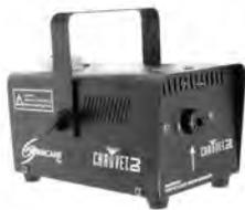
Máquina de humo. Potencia: 400W. Salida de humo: 42,5 m<sup>3</sup> / minuto. Tiempo de calentamiento: 2 minutos aprox. Capacidad del depósito: 0,6 litros. Modo de control:- MANUAL- Mando remoto por cable con pulsador de disparo (incluido). Conector: IEC IN. Alimentación 230V; 50Hz. Dimensiones: 215x180x124mm. Peso 1,8 Kg.
