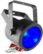
Proyector de leds COB UV. 1 led de 70W. Sin lente 100º y con lente fresnel 50º. Control DMX, Master/Slave, Wireless D-FI (opcional) y mediante infrarrojos (IRC-6 opcional). Conectores: IEC IN/OUT, XLR IN/OUT de 3 polos. Control DMX: 1 ó 5 CH. Consumo: 72W. Alimentación: 100-240V AC, 50/60Hz. Dimensiones: 139x200x253mm. Peso: 2.1 Kg.
