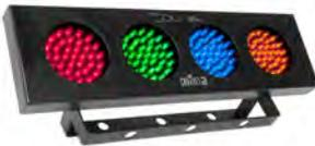
Proyector 4 focos de leds, 1 de cada color. 140 leds de 5mm (35 rojos, 35 verdes, 35 azul y 35 ámbar) de 0,25W. 541 lux a 2m. Lente de 14°. Control al ritmo de la música. Conectores: IEC IN. Alimentación 100-240V; 50/60 Hz. Dimensiones: 401x114x140mm. Peso 1,4 Kg.
