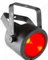
Proyector de leds COB RGB. 1 led de 40W (3 en 1). 1.660 lux a 2 m con lente de 20°, 243 lux a 2 m, (sin lente), 40°. Control DMX, Master/Slave, Wireless D-FI (opcional) y mediante infrarrojos, (IRC-6 opcional). Conectores: IEC IN/OUT, XLR IN/OUT de 3 polos. Control DMX: 3 ó 8 CH. Consumo: 46W. Alimentación: 100-240V AC, 50/60Hz. Dimensiones: 132x189x242mm. Peso: 1.6 Kg.
