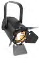
Proyector compacto con LED COB de 20W con lente Soft, (2,700°K). 1.506 lux a 2 m a 24°. Viseras de recorte. Adaptador para carril electrificado (opcional). Alimentación 100-240V; 50/60Hz. Dimensiones: 154x140x184mm. Peso 1,2 Kg.
