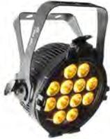
Proyector de leds CW,WW,A. 12 leds de 6W (3 en 1). 3.097 lux a 2 m con lente de 17°. Temperatura de blanco de 1,700° a 6,300°. Control DMX, Master/Slave, Wireless D-FI (opcional) y mediante infrarrojos, (IRC-6 opcional). Conectores: IEC IN/OUT, XLR IN/OUT de 3 polos. Control DMX: 3, 4 ó 9 Ch. Consumo: 58W. Carcasa de aluminio. Alimentación: 100-240V AC, 50/60Hz. Dimensiones: 253x98x290mm. Peso: 3.2 Kg.
