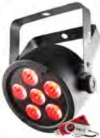
Proyector de leds RGB. 6 leds de 3W (3 en 1). 1.621 lux a 2 m con lente de 15°. Control DMX, Master/Slave, al ritmo de la música, Wireless D-Fi (opcional) y mediante infrarrojos, (IRC-6 opcional). Conectores: IEC IN/OUT, XLR IN/OUT de 3 polos. Control DMX: 3 ó 8 Ch. Consumo: 20W. Alimentación: 100-240V AC, 50/60Hz. Dimensiones: 181x84x226mm. Peso: 1.1 Kg.
