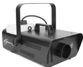
Máquina de humo. Potencia: 1070W. Salida de humo: 565 m3 / minuto. Tiempo de calentamiento 5,5 minutos. Capacidad del depósito: 3,3 litros. Modos de control: -Manual- interruptor en la misma máquina, - Remoto- con cable con pulsador de disparo y control de timer (incluido). Conector: IEC IN. Alimentación 230V; 50Hz. Dimensiones: 420x320x302 mm. Peso 6,9 Kg.
