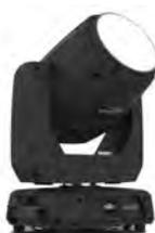
Cabeza móvil led Beam. 1 led de 100W, Blanco, 262.800 lux a 2 m. Lente de 3°. Rueda de colores 8 + blanco. Rueda de gobos de 5 gobos fijos + blanco. Strobe de 0-20 flashes por segundo. Display LCD. Control DMX, automático, Master/Slave ó al ritmo de la música. Control DMX 8 ó 14 canales. Pan: 540, Tilt: 270. Conectores: PowerCom IN/OUT, XLR IN/OUT de 3 polos. Consumo: 269W. Alimentación 100-240V; 50/60 Hz. Dimensiones: 480x322x220mm. Peso 11.6 Kg.
