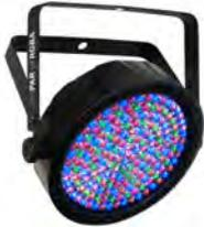
Proyector de leds RGBA. 180 leds de 0,25W (39 rojos, 39 verdes, 51 azules y 51 ámbar). 1.325 lux a 2 m con lente de 14°. Control DMX, Master/Slave y al ritmo de la música. Conectores: IEC IN/OUT, XLR IN/OUT de 3 polos. Control DMX: 4 ó 8 Ch. Consumo: 33W. Alimentación: 100-240V AC, 50/60Hz. Dimensiones: 276x66x275mm. Peso: 1.3 Kg.
