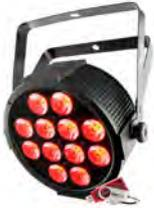
Proyector de leds RGBA. 12 leds de 4W (4 en 1). 4.960 lux a 2 m con lente de 19°. Control DMX, Master/Slave, Wireless D-FI (opcional) y mediante infrarrojos, (IRC-6 opcional). Conectores: IEC IN/OUT, XLR IN/OUT de 3 polos. Control DMX: 4 ó 9 Ch. Consumo: 58W. Alimentación: 100-240V AC, 50/60Hz. Dimensiones: 247x92x293mm. Peso: 2.2 Kg.
