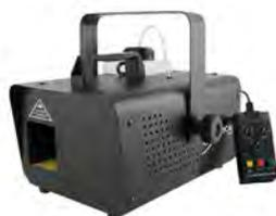
Máquina de niebla. Potencia: 800W. Salida de 20 m3 / minuto. Tiempo de calentamiento: 1 minuto. Capacidad del depósito: 1,5 litros. Modos de control: -Manual- interruptor en la misma máquina, Remoto- con cable con pulsador de disparo y regulación de la salida de niebla y la velocidad del ventilador ó DMX: 1 CH. Conectores: IEC IN/OUT, XLR IN/OUT de 3 polos. Alimentación 230V; 50Hz. Dimensiones: 318x268x250mm. Peso 3,7 Kg.
