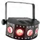
Efecto múltiple con led 2 en 1. Combina un array de 5 leds RGB-UV de 6W con 30 leds SMD RGB de 0,3W. Combinando estos efectos es posible crear un sinfín de efectos diferentes. Control DMX, Master/Slave, automático, al ritmo de la música y mediante infrarrojos (IRC-6 opcional). 3,10 ó 30 canales DMX. Consumo 32W. Conectores: IEC IN/OUT, XLR IN/OUT de 3 polos. Alimentación 100-240V; 50/60Hz. Dimensiones: 285x207x155mm. Peso 1,6 Kg.
