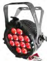
Proyector de leds RGBA. 12 leds de 6W (4 en 1). 4.220 lux a 2 m con lente de 16º. Control DMX, Master/Slave, Wireless D-FI (opcional) y mediante infrarrojos, (IRC-6 opcional). Conectores: IEC IN/OUT, XLR IN/OUT de 3 polos. Control DMX: 4, 5 ó 10 Ch. Consumo: 78W. Carcasa de aluminio. Alimentación: 100-240V AC, 50/60Hz. Dimensiones: 253x98x290mm. Peso: 3.3 Kg.
