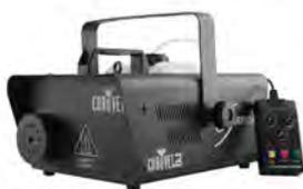
Máquina de humo. Potencia: 1500W. Salida de humo: 708 m3 / minuto. Tiempo de calentamiento ultra rápido. Capacidad del depósito: 2,4 litros. Tanque con iluminación LED para facilitar el monitoreo del nivel de fluido. Sensor de falta de líquido con apagado automático. Modos de control: DMX 1 canal, Manual- interruptor en la misma máquina, - Remoto- con cable con pulsador de disparo y control de timer (incluido). Conector: IEC IN. Alimentación 230V; 50Hz. Dimensiones: 348x312x253mm. Peso 6 Kg.
