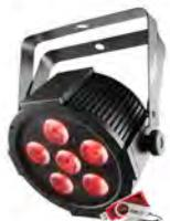
Proyector de leds RGBA. 6 leds de 4W (4 en 1). 2.684 lux a 2 m con lente de 19°. Control DMX, Master/Slave, Wireless D-FI (opcional) y mediante infrarrojos, (IRC-6 opcional). Conectores: IEC IN/OUT, XLR IN/OUT de 3 polos. Control DMX: 4 ó 9 Ch. Consumo: 28W. Alimentación: 100-240V AC, 50/60Hz. Dimensiones: 212x92x244mm. Peso: 1.6 Kg.
